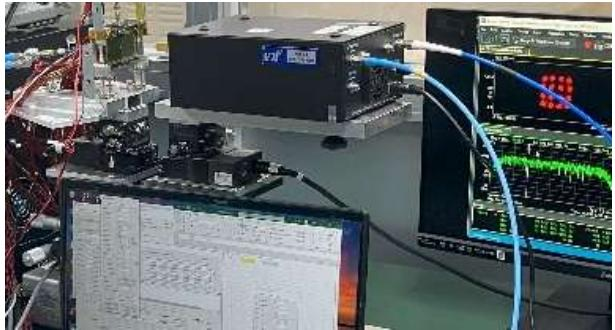
300GHz 帯 CMOS フェーズドアレイトランシーバによる
