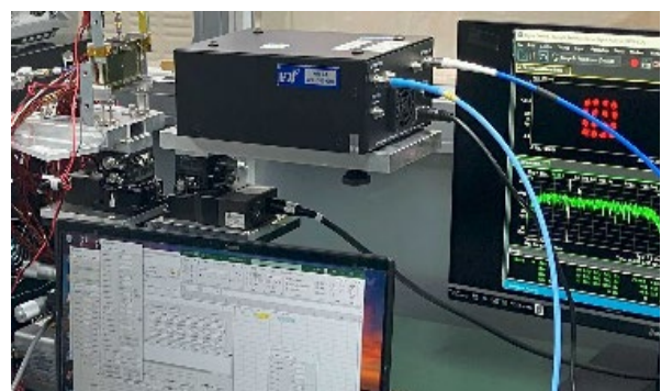
300GHz 帯 CMOS フェーズドアレイトランシーバによる高速無線伝送実験
