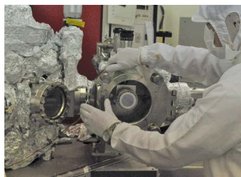
スパッタリング装置ウェハセッティング風景
