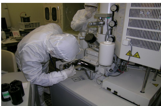
SEMロードロック室へのウェハセッティング風景 Wafer setting to SEM load-lock chamber
